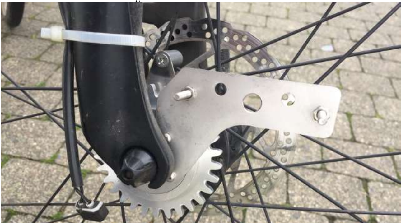
Dieser hat den Vorteil, dass man das Zählwerk abmontieren kann, ohne das Vorderrad ausbauen zu müssen.
